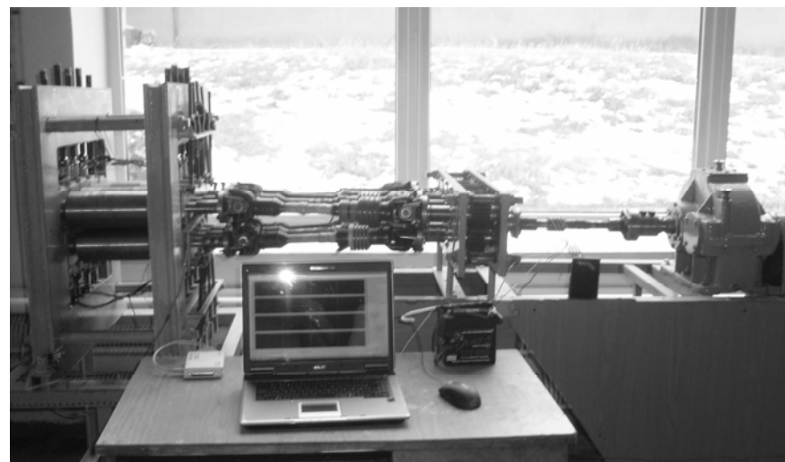
Рис. 1. Общий вид экспериментальной установки для исследования процесса правки относительно толстых листов
